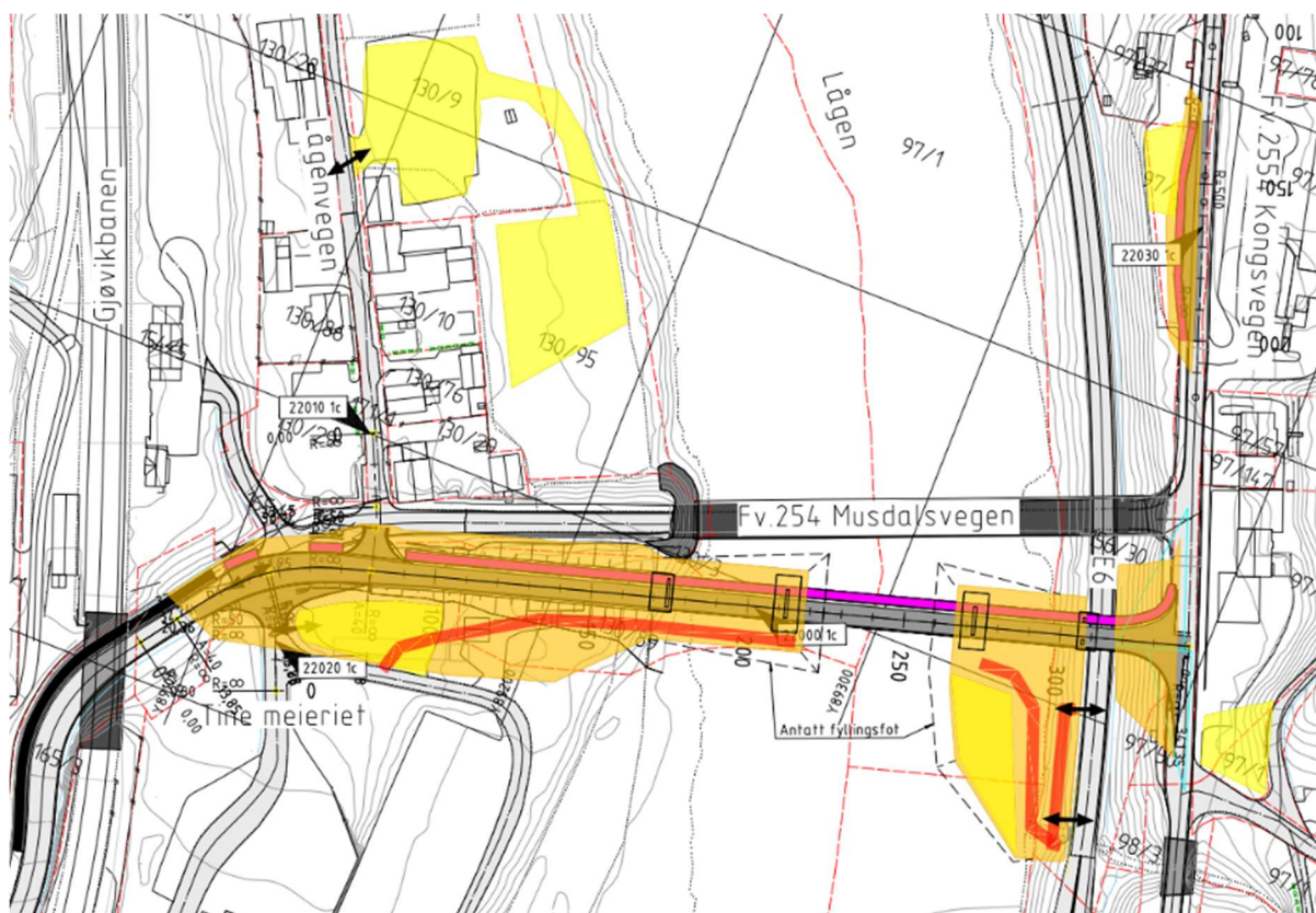
Figur 1-11 Alternativ 2 - Bru nedstrøms dagens bru anleggsgjennomføring (COWI, 2024)
