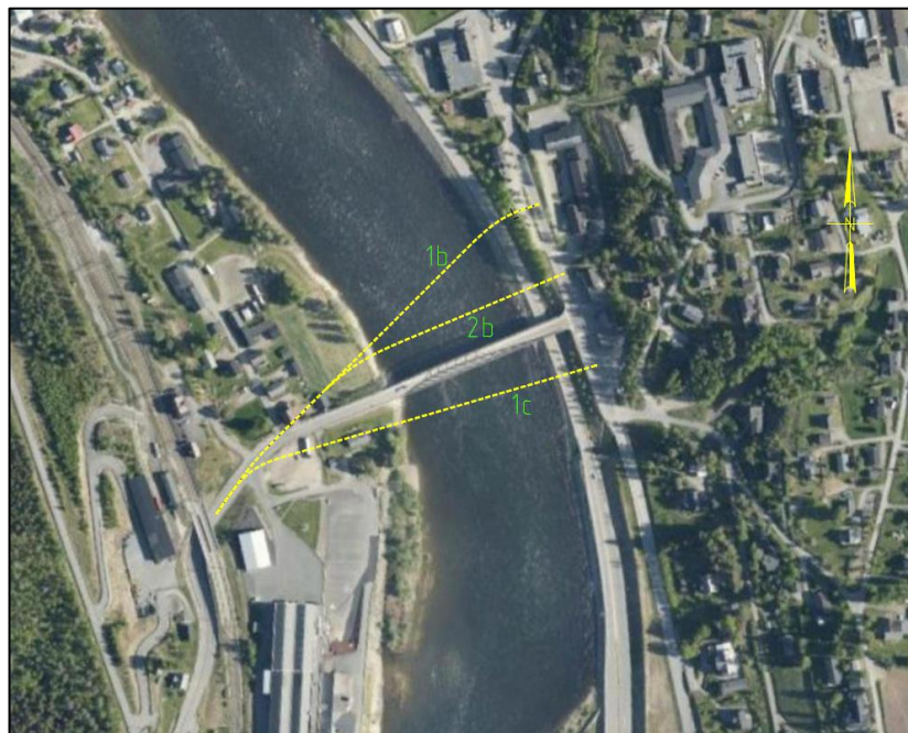
Figur 3-1 Veglinjer som er vurdert, midlertidig bru vist mellom veglinje 2b og 1c. Kilde: COWI.
