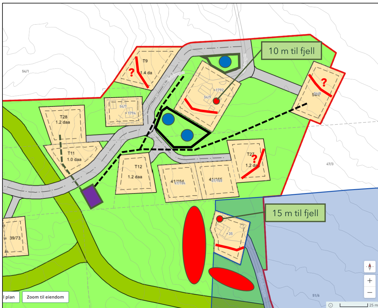
Figur 8: Forslag til felles VA-løsninger for den nordvestre del av hyttefeltet. Mulige infiltrasjonsmuligheter for avløpsvann i stedlige morenemasser er vist med rødt. Mulig lokalisering av felles vannverk er vist med blå farge.
