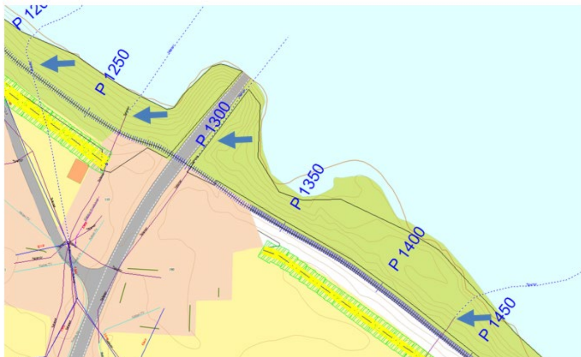
Figur 12. Fire eksisterende telecomkabler eid av Telenor krysser flomvollen ved Arneberg bru (markert med blå piler).
