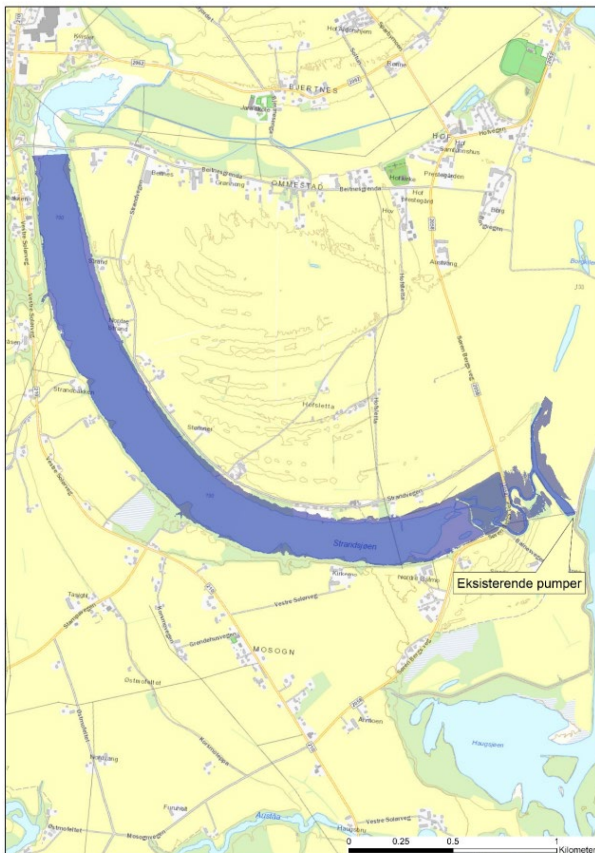
Figur 6. Flomvannstand i sidevassdraget som omfatter Strandsjøen ved Q_{200} + 20\% klimapåslag, med selvfallsledning til Glomma stengt og pumpekapasitet 2,5 \text{ m}^3/\text{s} .
