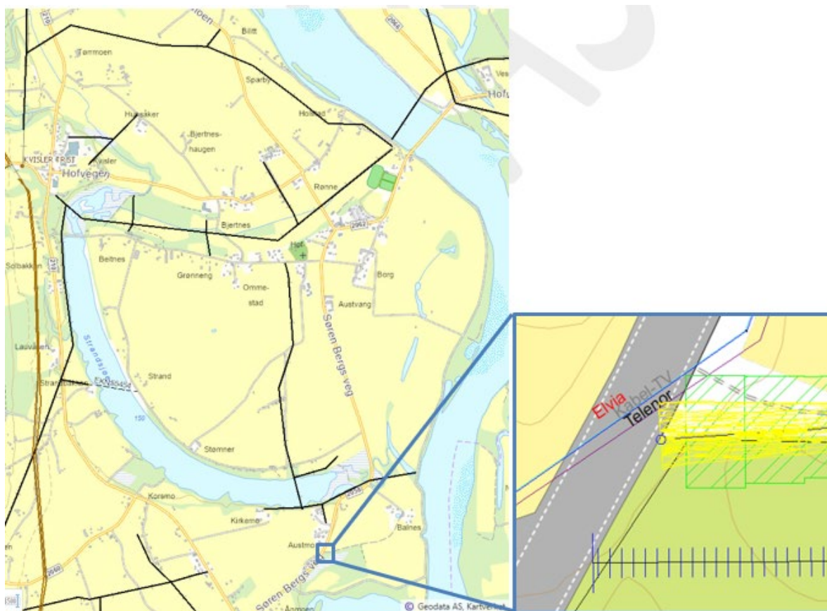
Figur 11. Eksisterende nettanlegg for framføring av kraft vist med svarte linjer på bildet til venstre. Kilde: NVE Atlas 05.09.2025. Det ligger telecom kabler i bakken ved Søren Bergs veg (bildet til høyre).
