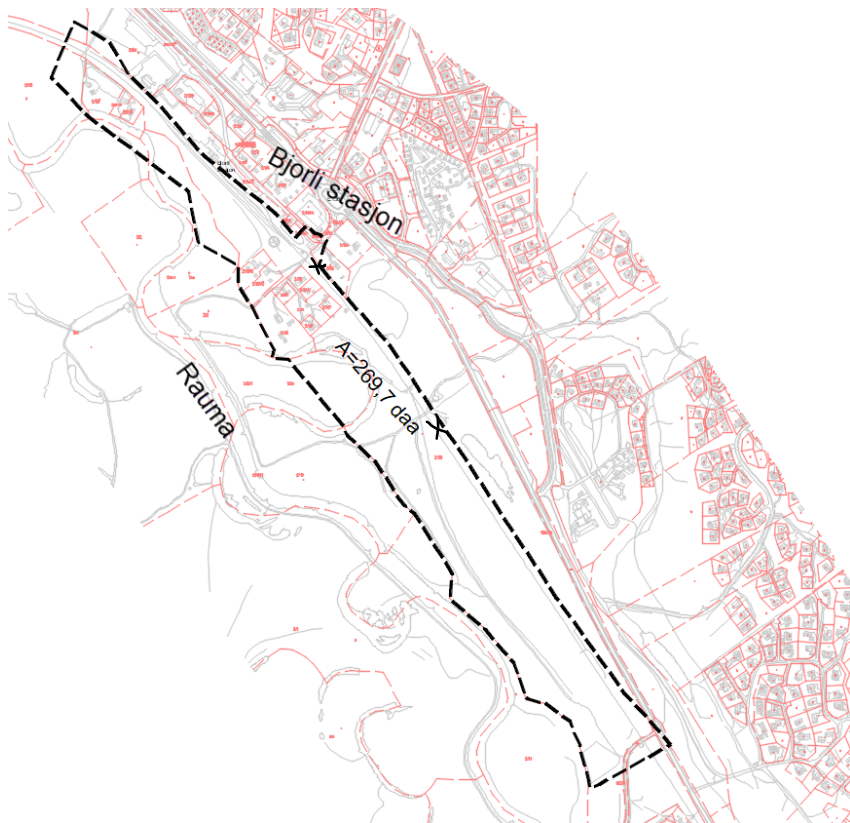
Figur 1. Planavgrensning ved varsling av oppstart markert med svart stiplet linje. Kryssene representerer forslag til stengte planoverganger.
