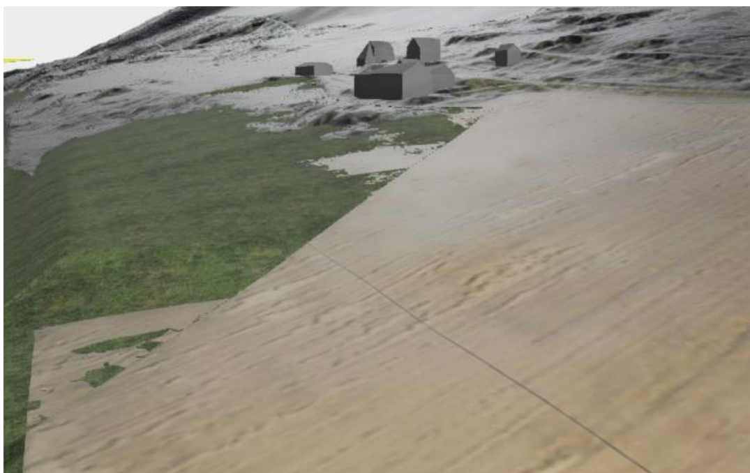
Figur 5-27. Løsningen forutsetter en heving av terrenget på innsiden av Fylkesvegen. Dette muliggjør en oppdyrking av arealet opp mot gården. Det hevede arealet får mindre helning enn tilstøtende areal.
