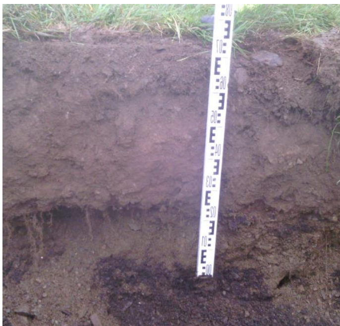
Figur 2-20. Jordprofil fra Bulung gård. Tykkelse A-sjikt mellom 25 cm, B-sjikt 25 cm. Under B-sjikt er det et lag med relativt fin grus før man kommer ned på et område med skiferholdig jord.
