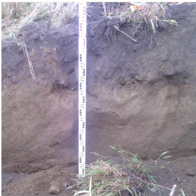
Figur 2-7. Jordprofil tatt på gården Brattstigen. Tykkelse A-sjikt inntil 40 cm. Tydelig overgang fra A-sjikt til underliggende masser med hensyn til fargeforskjell og mer grusholdige masser. Lite utviklet B-sjikt, uten overgang mot C-sjikt. Totalt er det gravd 1,1 meter ned uten at det er registrert sjiktovergang.
