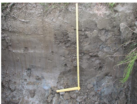
Figur 3-11. Vannmettet leirjord (til venstre) og vegetasjon med begynnende våtmarkspreg (til høyre) på riggområde forsøkt tilbakestilt til jordbruksareal uten reetablering av grøftesystem (Foto: Trond Knapp Haraldsen)
