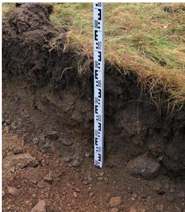
Figur 2-22. Jordprofil fra et areal som er brukt som beite (dyrkbar mark) på Bulung gård. Tykkelse på A-sjikt 20 cm, B-sjikt framstår som lite utviklet. Svært mye stein i profilet kan være med på å forklare hvorfor arealet ikke tidligere er fulldyrket.
