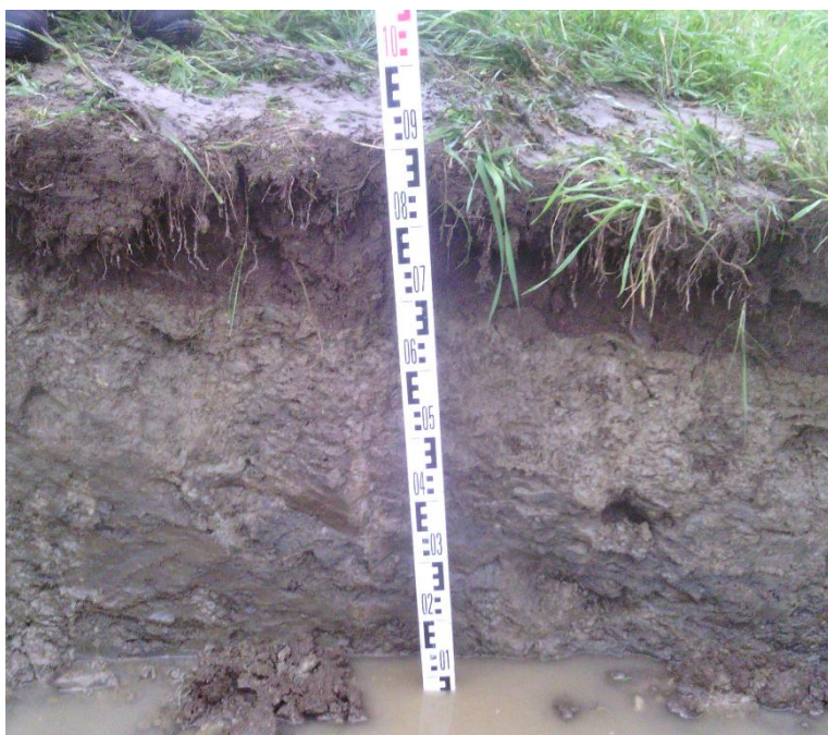
Figur 2-5. Jordprofil gravd på gården Gryte søndre øvre. Tykkelse A-sjikt omkring 25 cm. B-Sjikt 25 cm, men lite utviklet og framstår som relativt kompakt leire uten særlig rotutvikling. Relativt stor grad av vannmetning.
