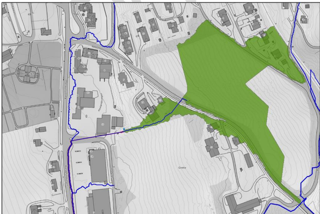
Figur 30 Illustrasjon av nedbørsfeltet, hentet fra notatet Flomvurderinger i Hov.
