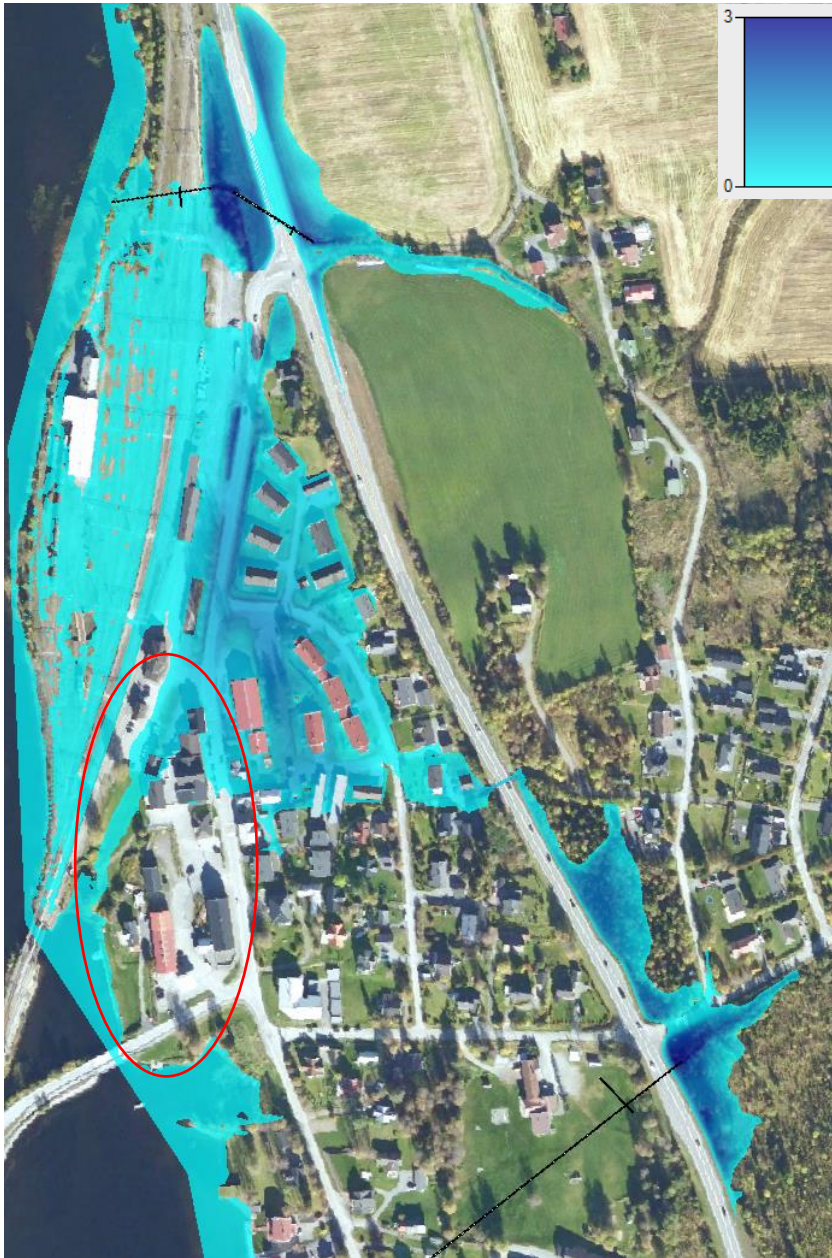
Figur 21 Maksimal utbredelse av flom som oppnås i en simulering med Q_{200+40\%} i Eina sentrum for Case 1. I denne simuleringen er kulvertene antatt tette. Aktuell eiendom er markert med rød sirkel. Skala for dybden går fra 0-3m, som vist øverst til høyre.
