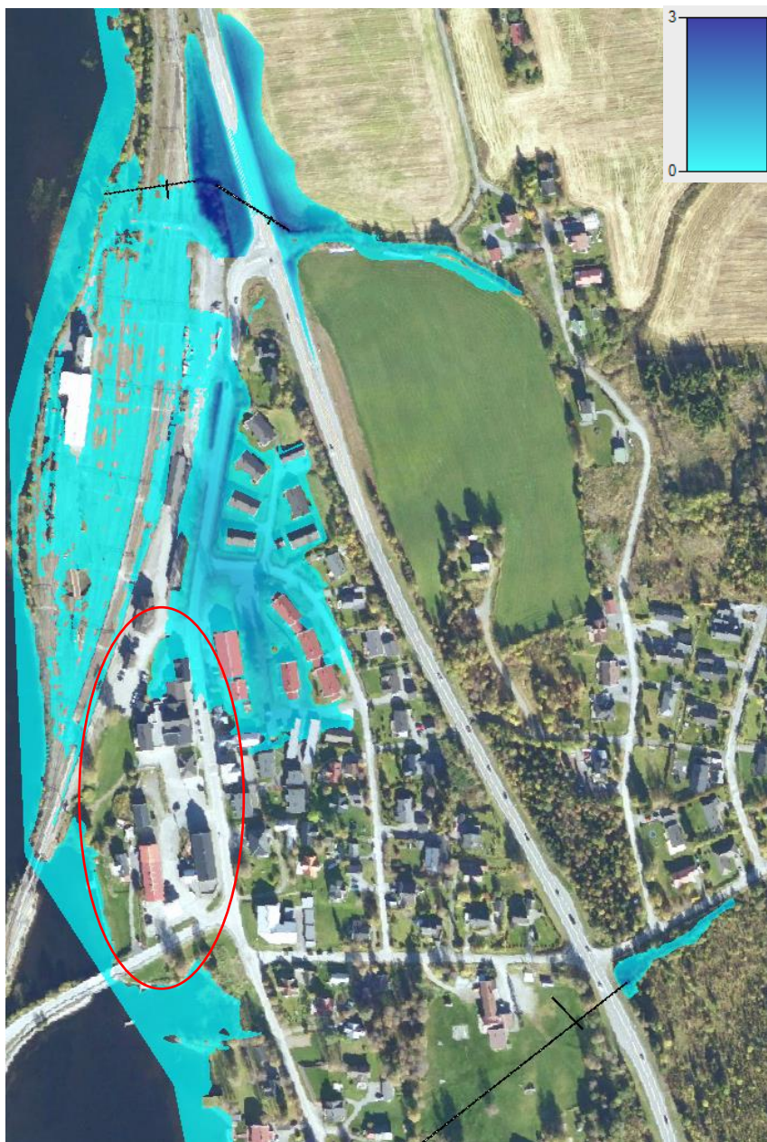
Figur 22 Maksimal utbredelse av flom som oppnås i en simulering med Q_{200+40\%} i Eina sentrum for Case 2. I denne simuleringen er kulvert 3 antatt åpen med utstikkende rørende som inntak. Aktuell eiendom er markert med rød sirkel. Skala for dybden går fra 0-3m, som vist øverst til høyre.
