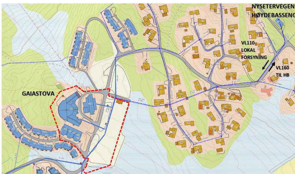
Situasjonsplan som viser dagens ledningsnett for vannforsyning
