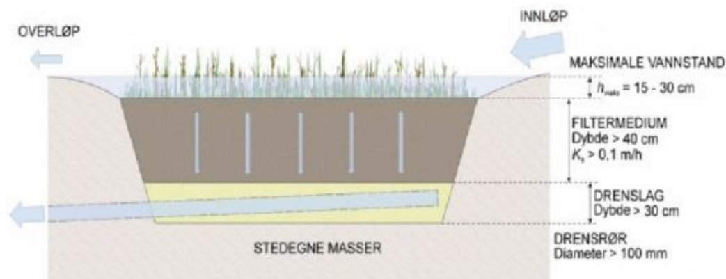
Figur 97 Prinsippskisse på utforming av regnbed. Kilde: Braskerud & Paus, 2016.
