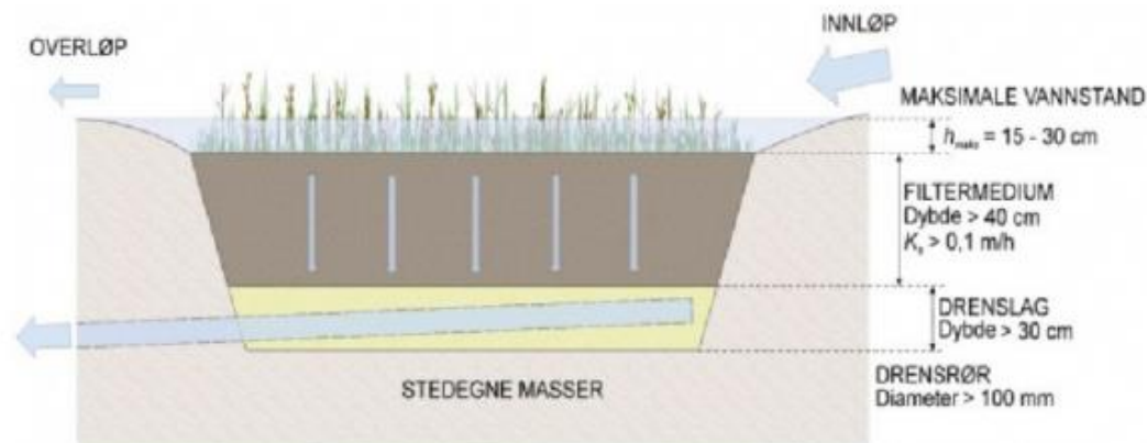
Figur 10 Prinsippskisse på utforming av regnbed. Kilde: Braskerud & Paus, 2016.
