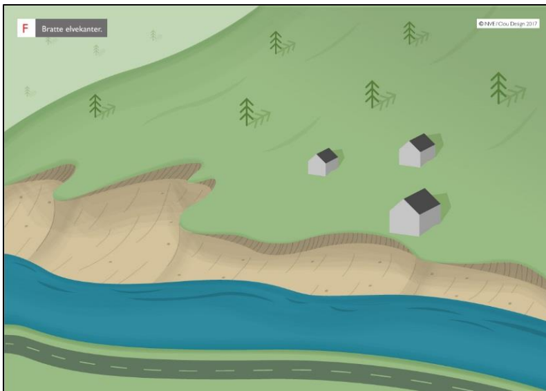
Figur 11. Stor vannføring kan erodere bratte elvekanter og føre til utglidning.
