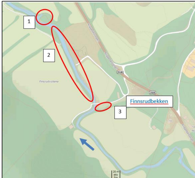
Figur 25. Augga ved Finnsrud. 1: Anlegge massefangdam for finmasser. 2: Massene fjernes fra elveløpet. 3: Etablere massefangdam i Finnsrubbekken ved utløpet.
