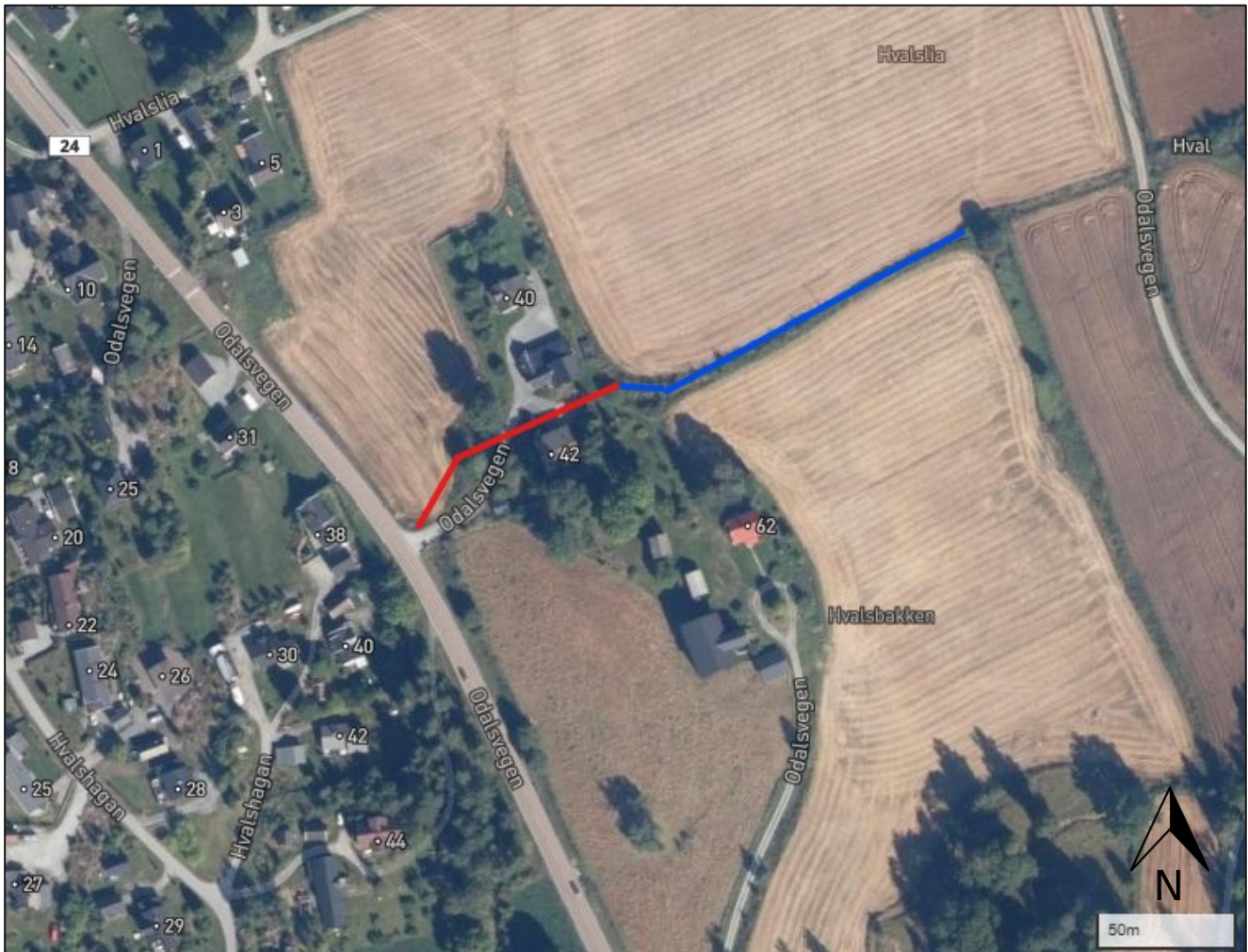
Figur 2.6: Bekkeløp som er delvis lagt i rør. Blå linje viser åpen strekning og rød viser lukket strekning. Knekkpunkt på rød linje markerer omtrentlig posisjon på kum iht. beskrivelse fra Innlandet fylkeskommune.
