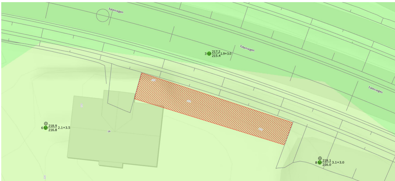
Figur 4-6: Omtrentlig utstrekning av støttemur i profil 120 - 140 sammenstilt med kvartærgeologisk kart og tilgjengelige grunnundersøkelser.
