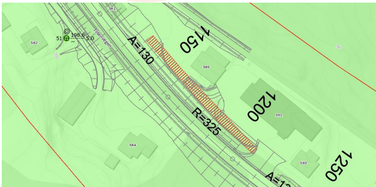
Figur 4-27: Omtrentlig utstrekning av støttemur i profil 1140 - 1215 sammenstilt med kvartærgeologisk kart og tilgjengelige grunnundersøkelser. 25
