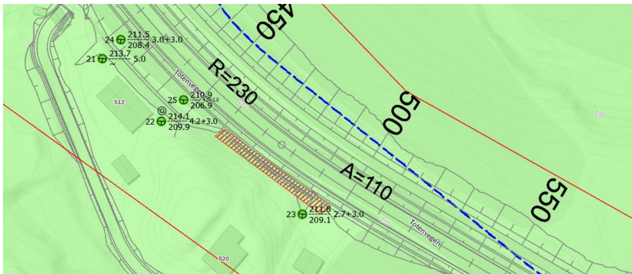
Figur 4-14: Omtrentlig utstrekning av støttemur i profil 460 - 500 sammenstilt med kvartærgeologisk kart og tilgjengelige grunnundersøkelser.
