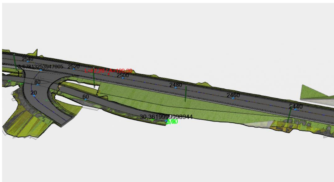
Figur 4-47: Strekning med oppstrammet vegfylling i profil 2450 – 2500. Beregningssnitt er tatt i profil 2480.
