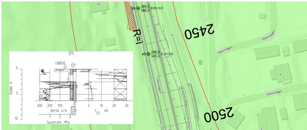
Figur 4-48: Plassering og opptegning av sondering 89 som er benyttet som grunnlag for grunnforhold i stabilitetsberegning.
