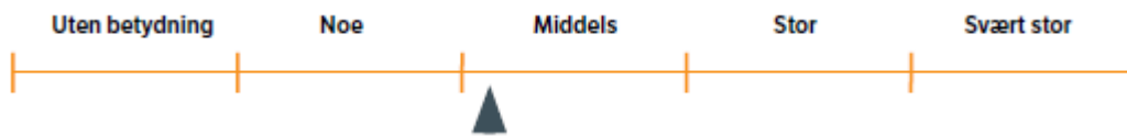
Figur 2-2: Skala for verdi. Skalaen er glidende og den sorte pila på undersiden kan flyttes langs skalaen for nyansering. Skalaen tilsvarer x-aksen i konsekvensviften i Figur 0-5. Kilde: Håndbok V712 Konsekvensanalyser s. 116 [5].
