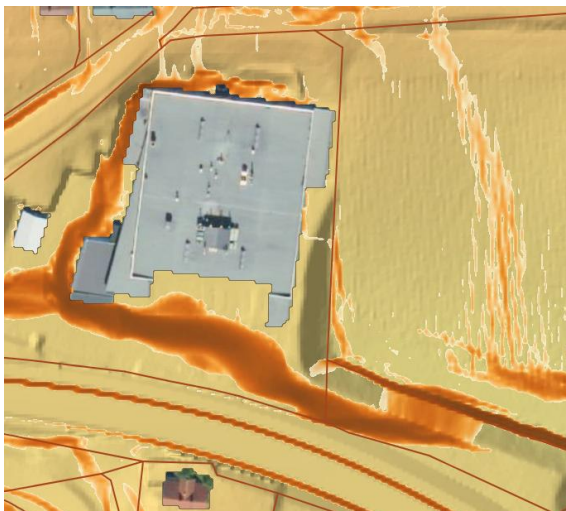
Figur 11: resultat fra hydraulisk modell i Scalgo for 200-års nedbørshendelse. Utsnitt fra Scalgo den 22/5-2026.
