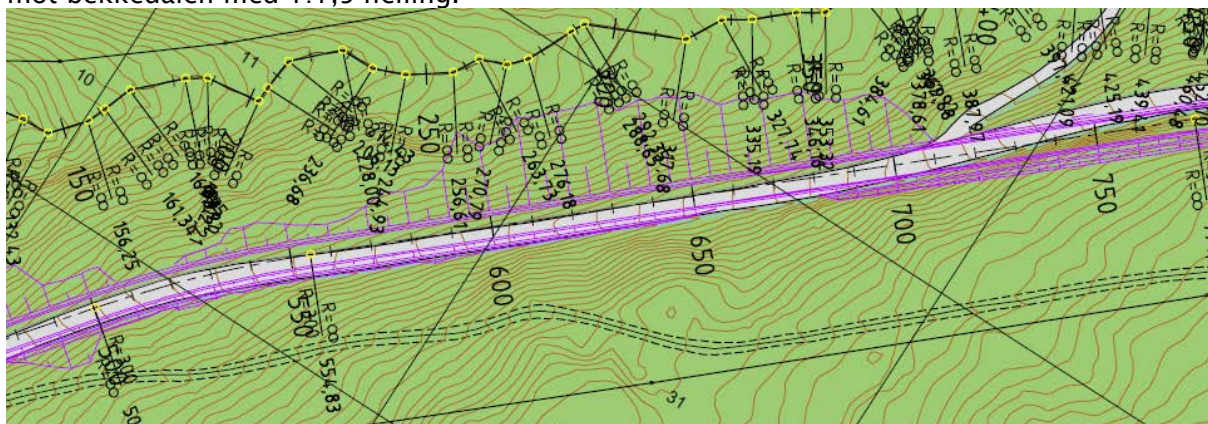
Figur 21: Viser utbedret veg mellom profil 480 og 750
