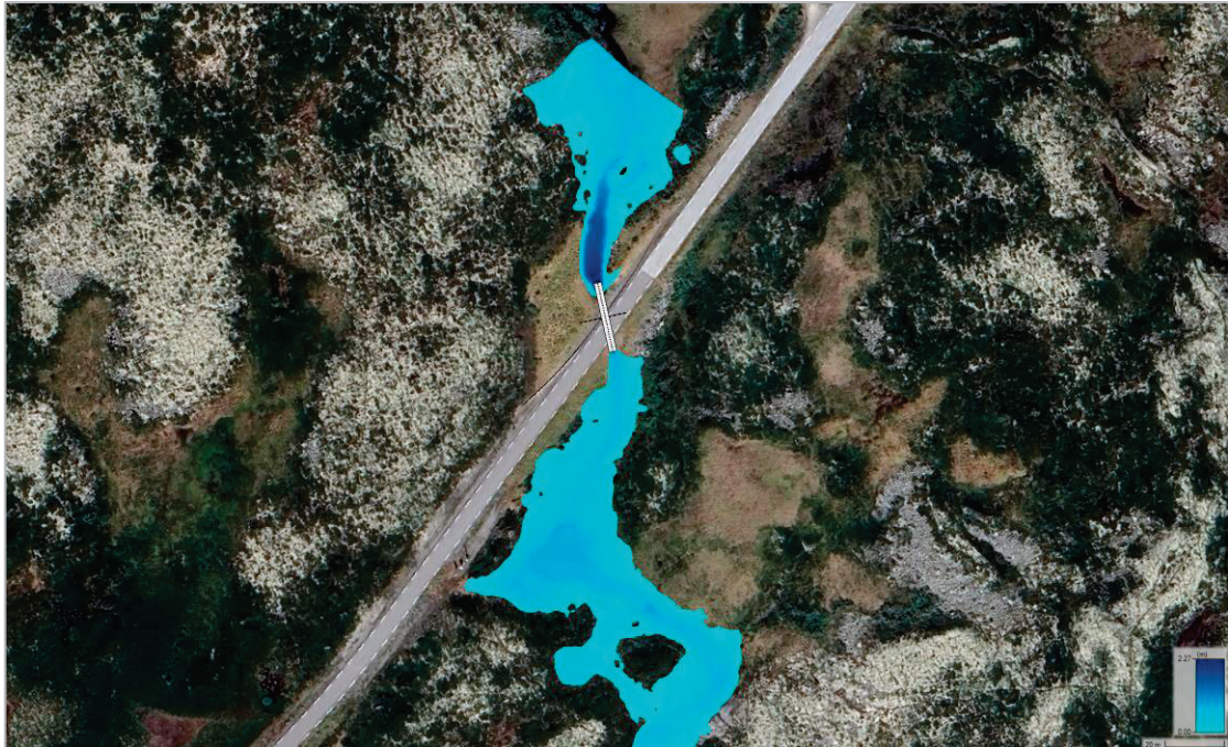
Figur 21: Flomsone ved Bølbekken ( Q_{200} på 7,60 \text{ m}^3/\text{s} ) - Ø2400 mm rør
