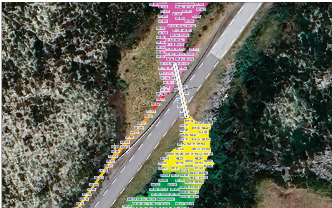
Figur 11: Vannstand (høydekote moh.) ved Bølbekken - 200 års flom, Ø2000 mm rør
