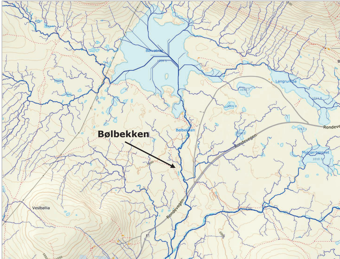
Figur 3: Utarbeidet avrenningslinjer ved bruk av SCALGO [2]
