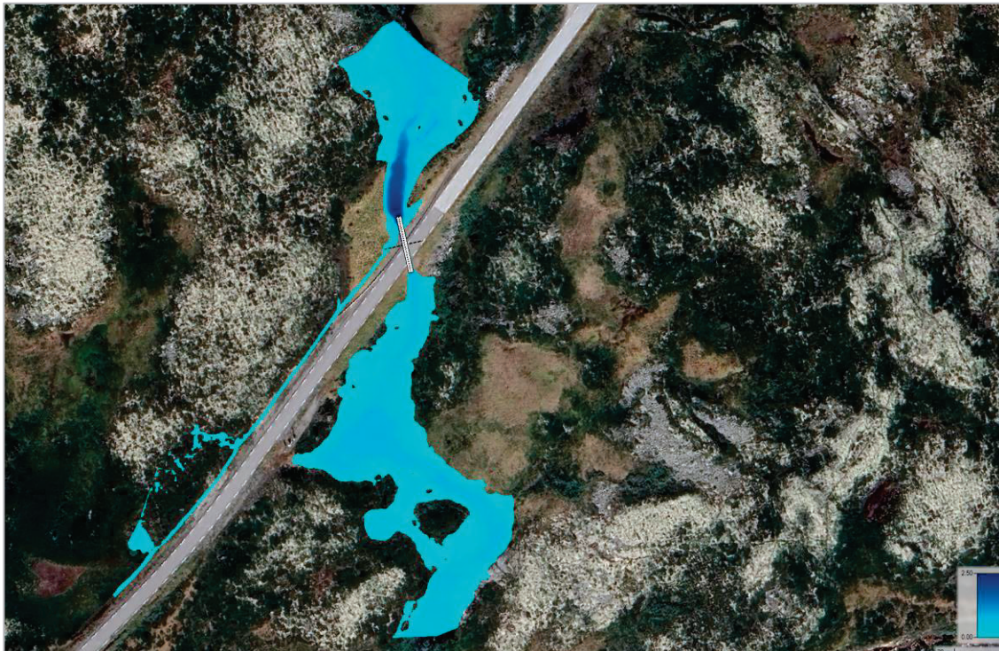
Figur 20: Flomsone ved Bølbekken ( Q_{200} på 7,60 \text{ m}^3/\text{s} ) - Ø2000 mm rør
