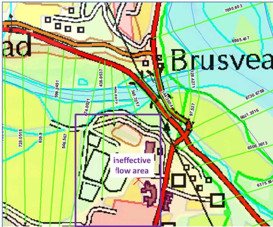
Figur 3.21: Ineffektive strømningsveier Gausa
