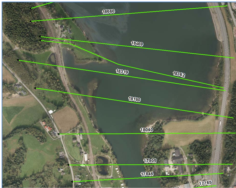
Figur 3.23: Eksempel på utvidelse og innsnevring av elva ved profil 18,362 og 18,319
